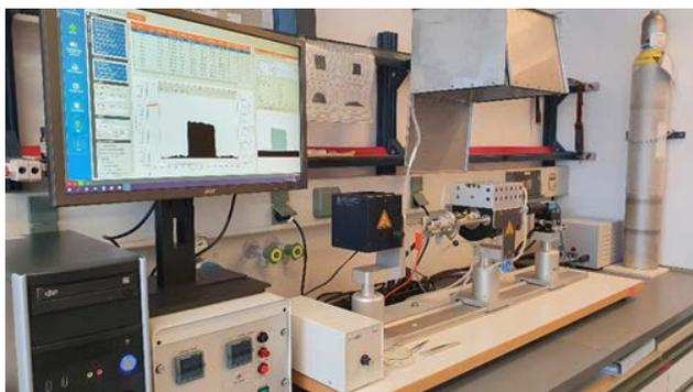
Abbildung 2: Das neue Erhitzungsmikroskop mit automatischer Bilderfassung und -Auswertung.
