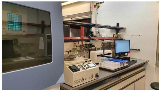
Abbildung 3: Die neue ETV-ICP-OES in Betrieb.
