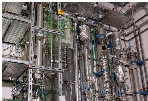
Ausschnitt der Fischer-Tropsch-Versuchsanlage am CUTEC
