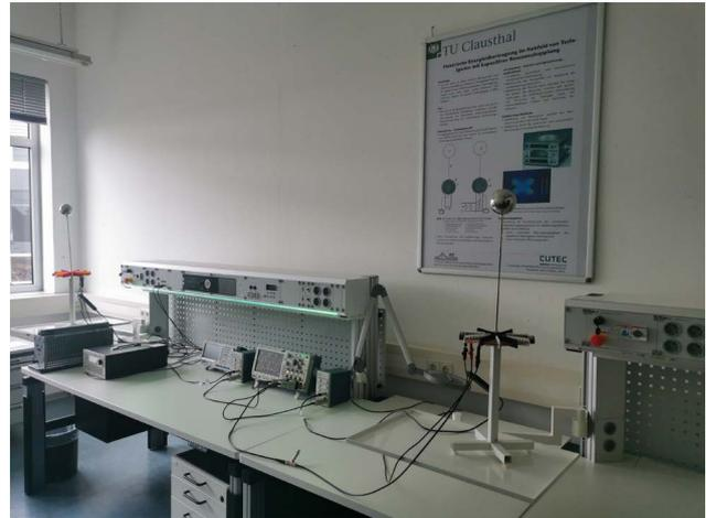
*Aufbau des Versuchs zur kontaktlosen Energieübertragung*
