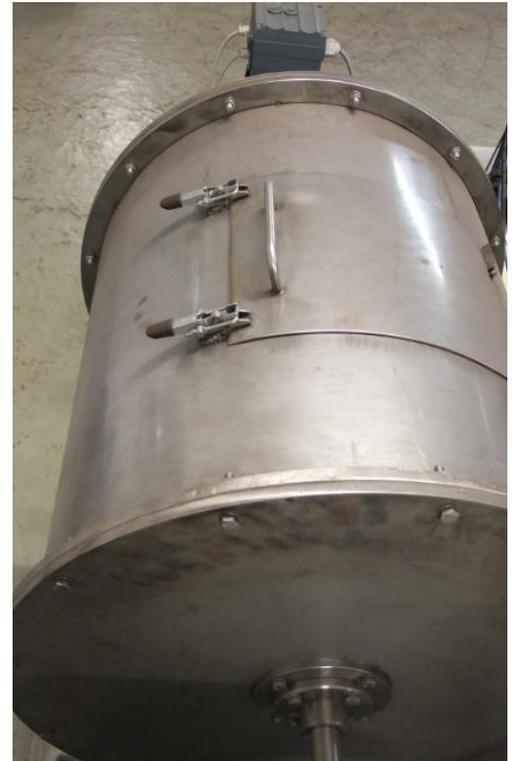
Der Trommeltester dient zur Bestimmung einer **Transportfestigkeit/-stabilität** durch Siebung in Fraktionen und Vergleich mit anderen (verwendeten) Materialien.
