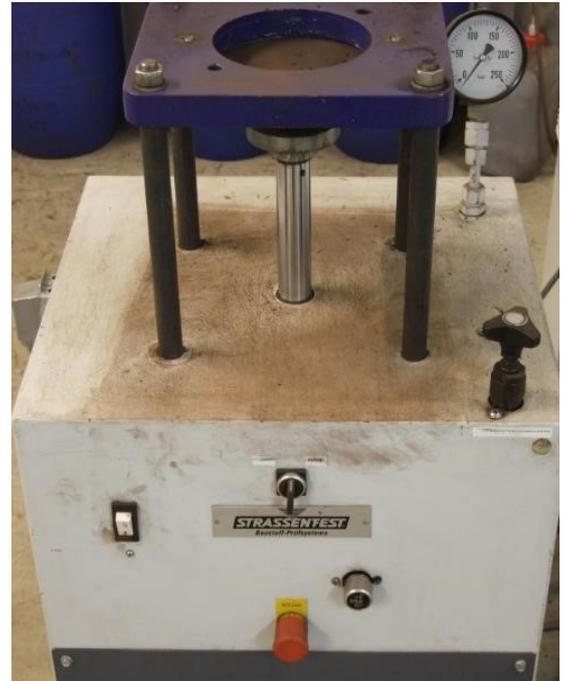
Die Prüfpresse dient zur Bestimmung von **Druckfestigkeit** und **Spaltzugfestigkeit**.
