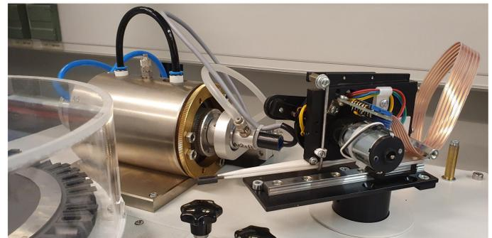
Abb. 1: ETV 4000d mit Probenhalter links und Probengreifer mit Probenschiffchen rechts
