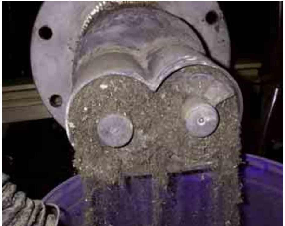
Algen in der Reaktoreintragsschnecke
