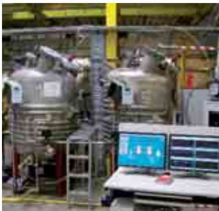
Biogasanlage im Technikumsmaßstab während eines Langzeitversuches
