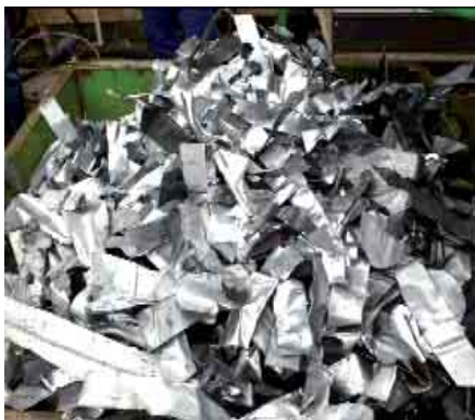
Zerkleinerte verzinkte Stahlschrottbleche
