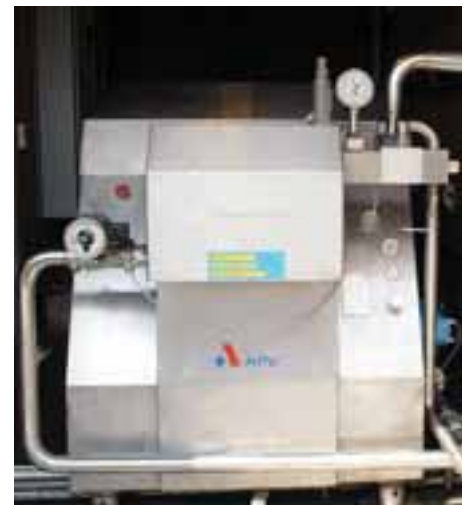
Der Homogenisator ist das „Herzstück“ der technischen Versuchsanlage
