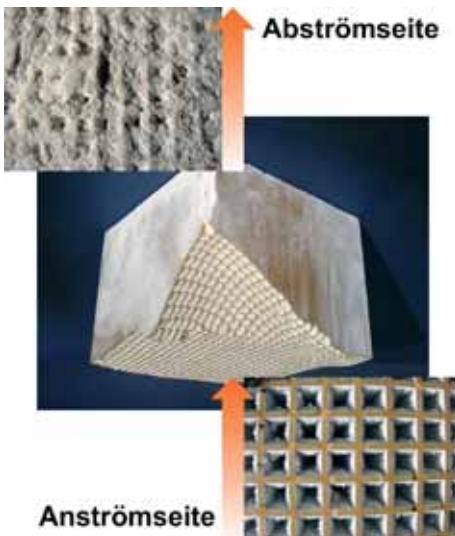
Siliziumoxidanhaftungen an dem Monolithen einer RNV-Anlage
