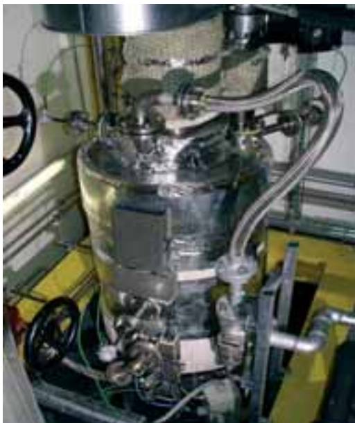
Heißgasfilter zur Mineralien-Rückgewinnung Hot gas filter for recycling of minerals
