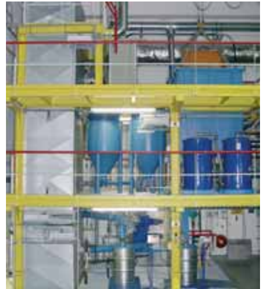
Zirkulierende Wirbelschicht als Vergaser für Biomasse
